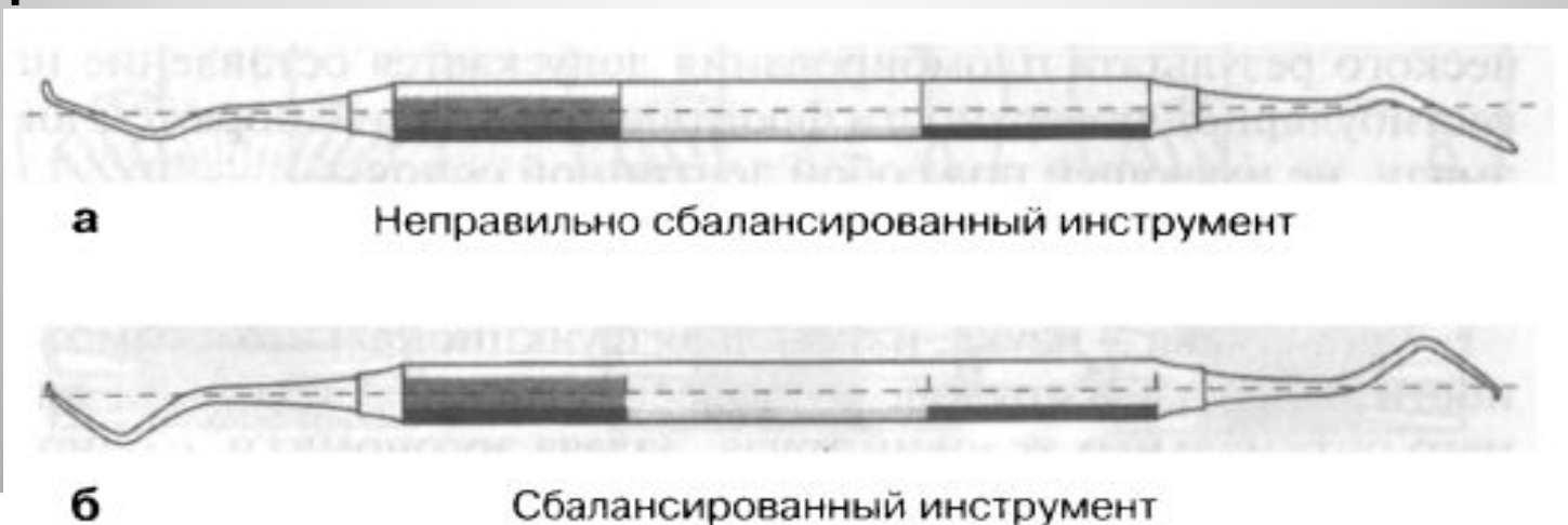
Рис. 88. Балансировка ручных стоматологических инструментов.
