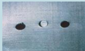
Рис. 4. Рамка вырезание отверстия (справа), легкое выделение обреза резжурки (в центре) и обычное отверстие после удаления обреза резжурки (слева)
