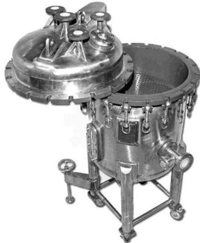
Рис. 55. Внешний вид закрытого нутч-фильтра
