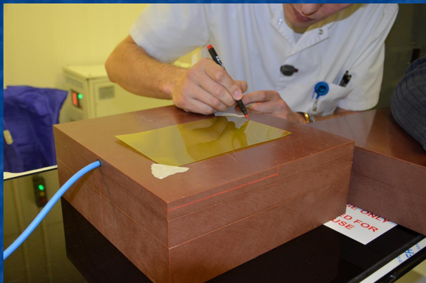
Рис. 4. Размещение пленки Gafchromic на адаптерной пластине фантома Virtual Water: а – установка фантома и фиксация пленки; б – разметка осей на пленке.
