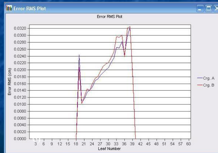
Рис. 13. Верификация на основе файлов Dynalog. Таблица (а) и график (б) среднеквадратичной ошибки положения каждого лепестка для банков А и В в процессе выполнения плана.
