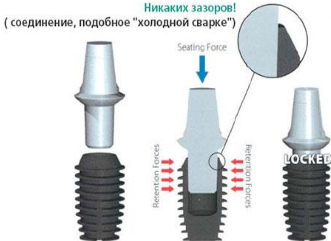
**Является опорно-соединительным элементом между имплантатом и полостью рта. Может быть стандартным и индивидуальным.**
