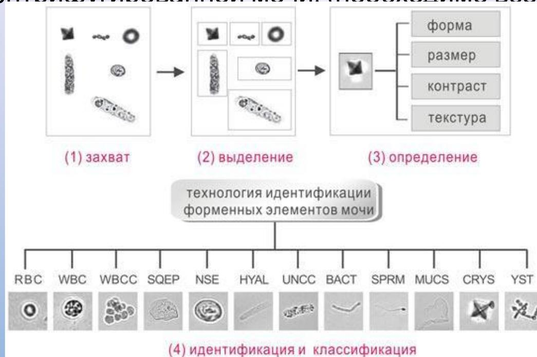
При исследовании для каждого образца автоматически создается сортированный архив всех найденных объектов вместе с их микрофотографиями. При этом имеется возможность визуальной коррекции полученных результатов оператором
