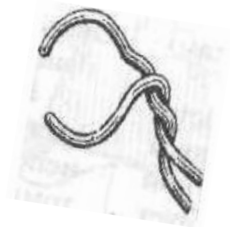
Проволочный двухплечий кляммер
