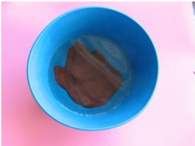
Разогревание термопластической массы в воде.
