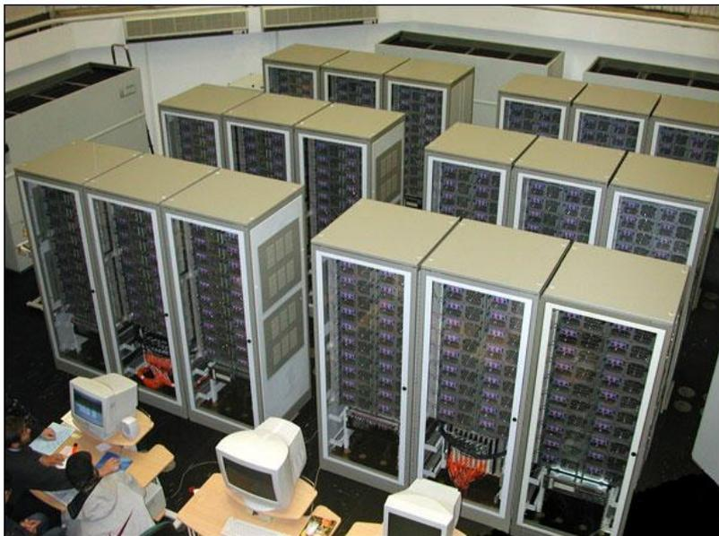
Суперкомпьютер **MBC 100K** - самая мощная в СНГ супер-ЭВМ, предназначен для решения сложных научно-технических задач. Содержит 1980 4-х ядерных процессоров Xeon (3 ГГц) и 4000 Гб оперативной памяти. Его пиковая производительность 98 TFlops.
