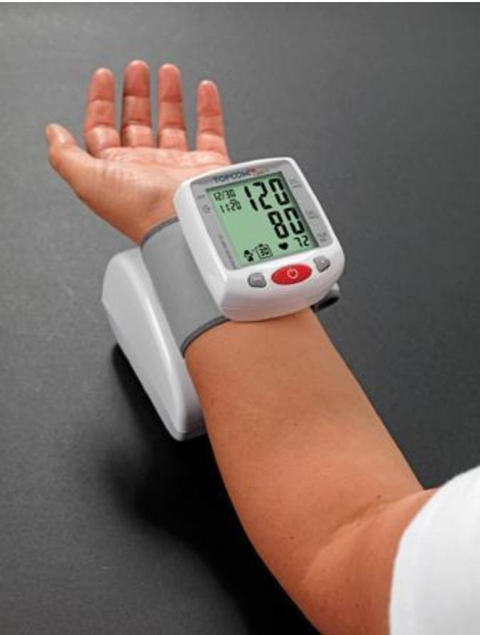
**В автоматических приборах измерение погрешности обычно производится сравнением показателей автоматического тонометра с результатами прослушивания тонов Короткова.**
