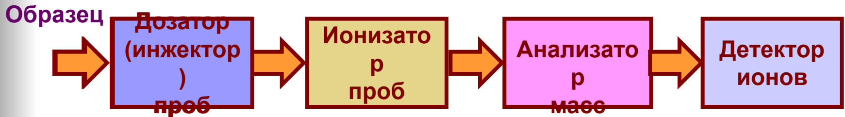
Принципиальная схема масс-спектрометра
