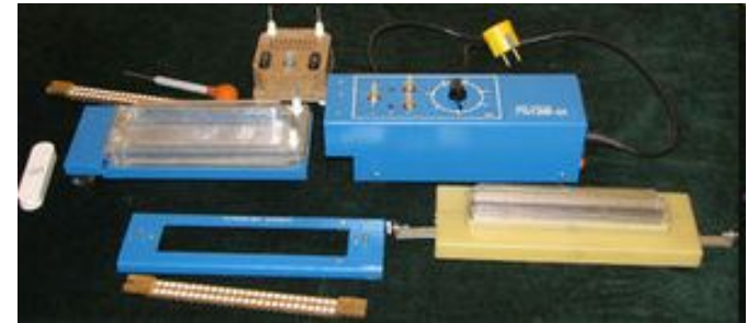
Прибор иммуноэлектрофоретический ПИЭФ-1
