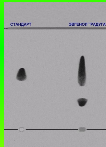
Хроматограмма эвгенола стоматологического фирмы «Радуга-Р»
