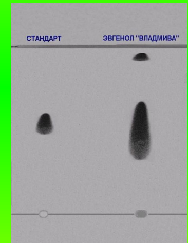
Хроматограмма эвгенола стоматологического фирмы «ВладМива»
