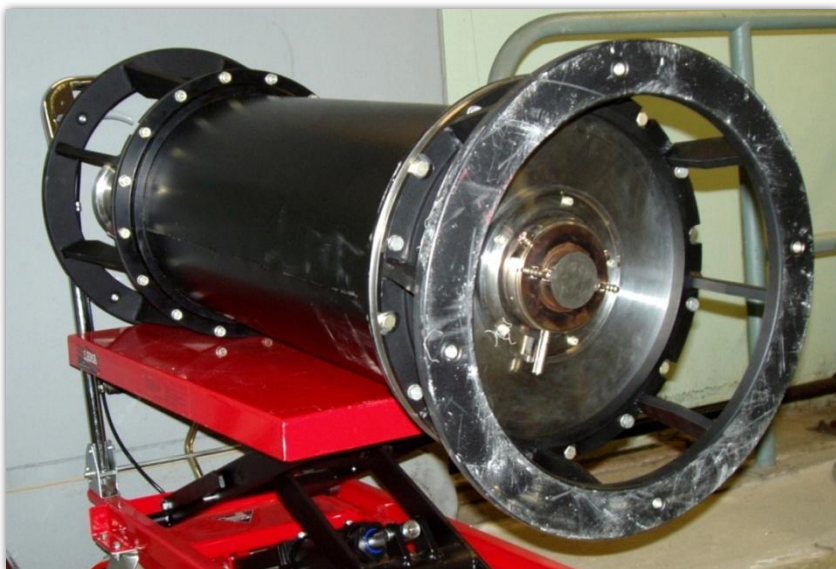
Внешний вид экспериментального образца генератора нейтронов с отпаянной трубкой
