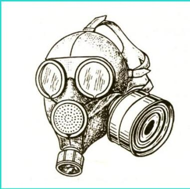
Противогаз предназначен для защиты от попадания в органы дыхания, на глаза и лицо человека отравляющих, радиоактивных, веществ и бактериальных средств.
