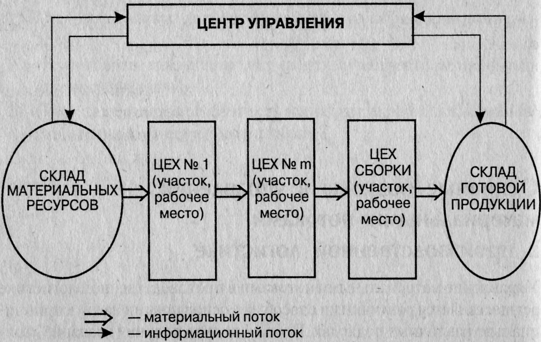
Общая схема функционирования толкающей системы
