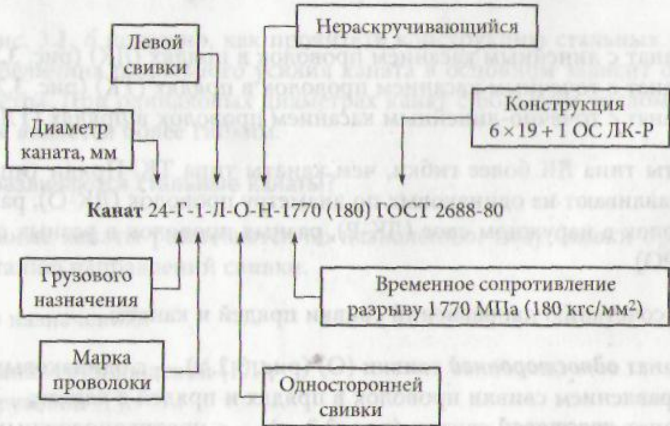
Рис. 3.3. Условное обозначение стального каната
