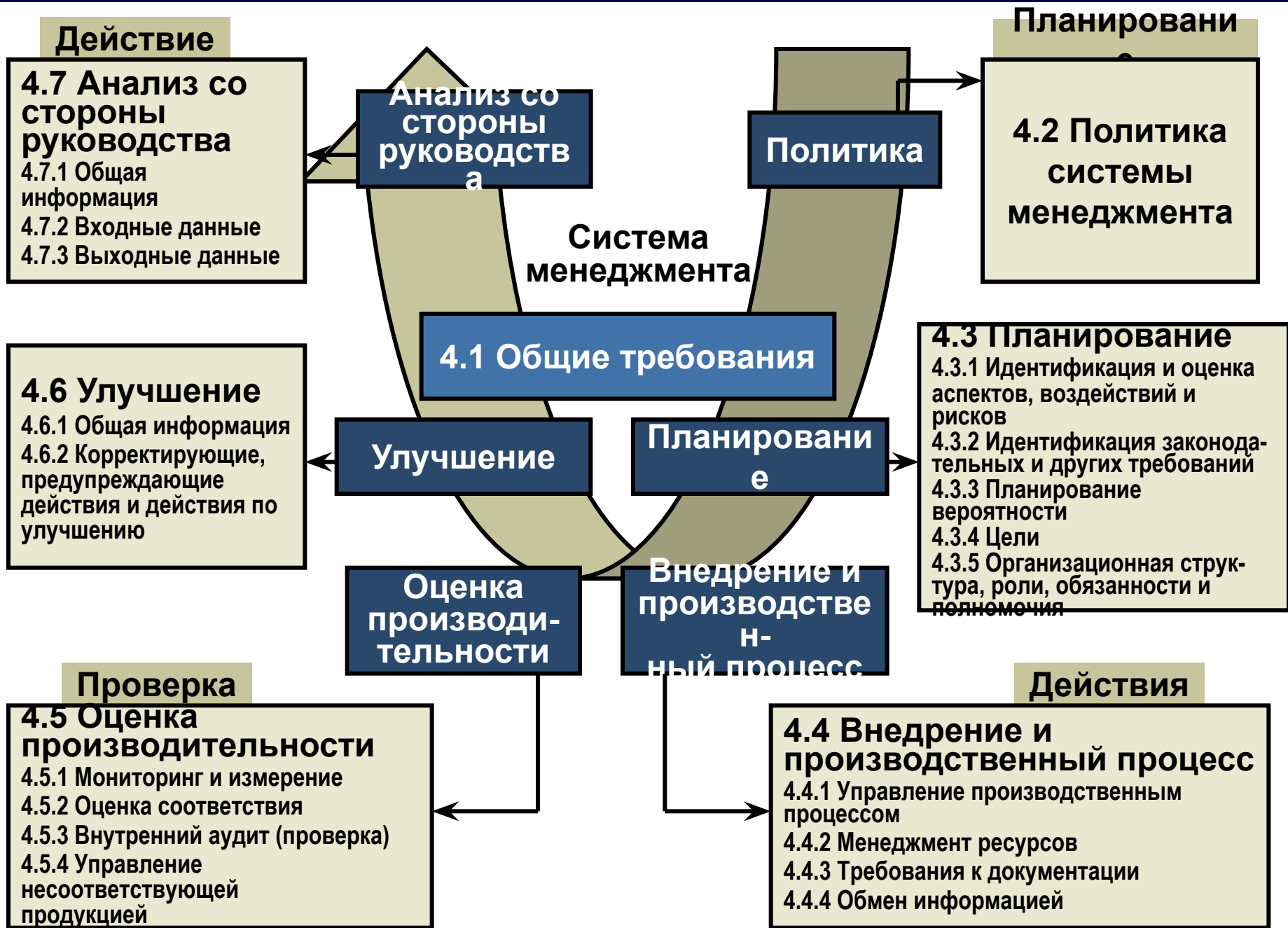
Схема объединения PDCA и общих требований с образованием структуры менеджмента (ГОСТ Р 53893, рис. 2)
