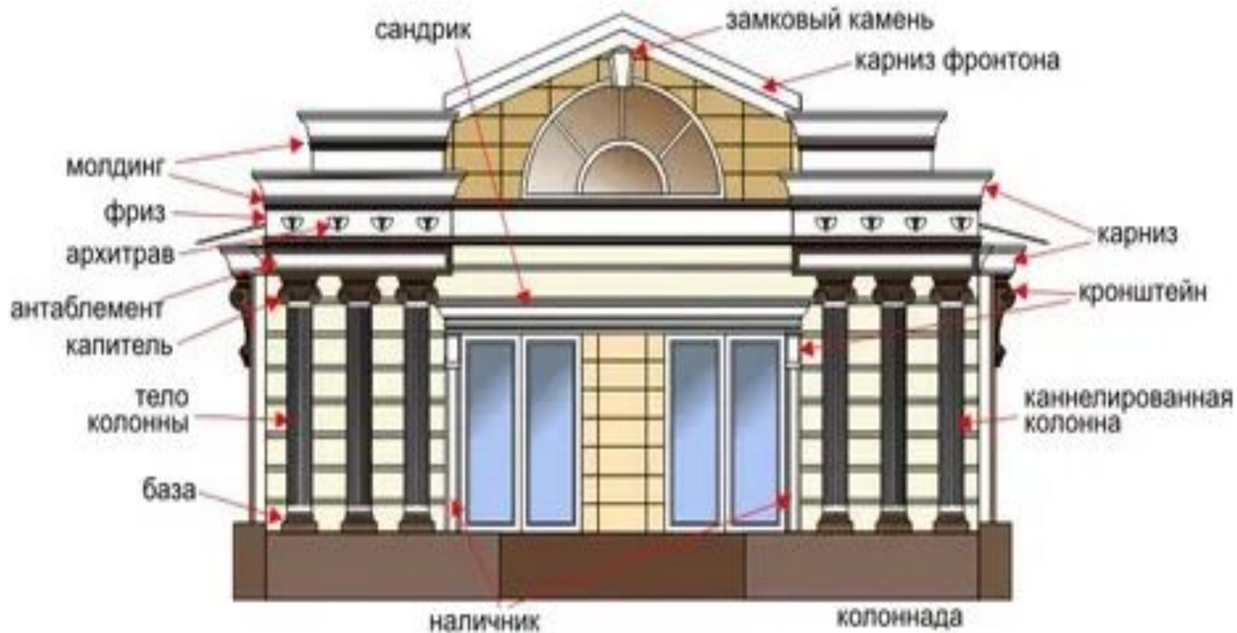
Верхняя горизонтальная часть сооружения, обычно лежащая на колоннах. Антаблемент разделяется на несущую часть — архитрав, — на опирающийся на него фриз и венчающую часть — карниз.
