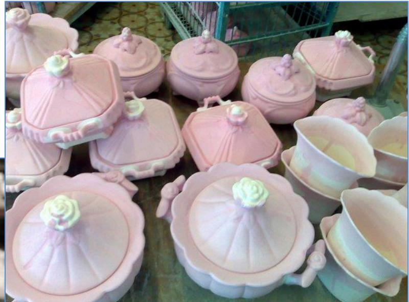
После предварительного обжига изделия проходят «фуксиновый контроль»: полуфабрикаты опускают в розовый нестойкий раствор фуксина, пропадающий под воздействием света. Этот технологический процесс даёт возможность проверить качество керамических изделий, делает заметными мелкие трошки и сколы.
