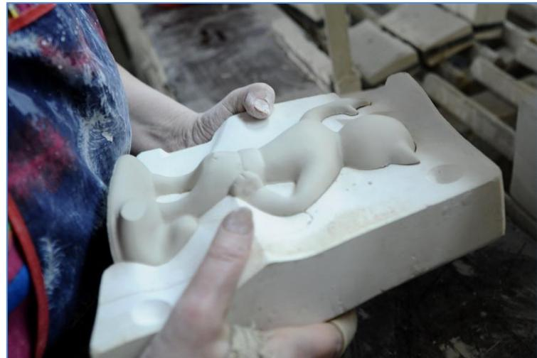
Пористый гипс вытягивает и впитывает влагу, шликер постепенно затвердевает, приобретая очертания формы. Далее форму раскрывают и достают полуфабрикат, вручную подправляют и заглаживают «швы».
