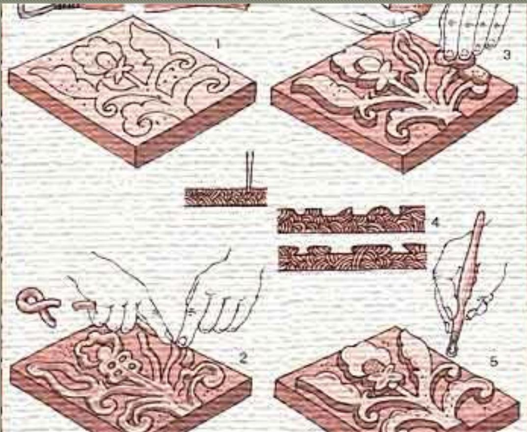
Для изготовления изразцов используются специальные формы – матрицы из дерева или глины. В них вырезается орнамент, который отпечатывается на глиняных плитках способом продавливания. Затвердевший изразец тщательно просушивают, расписывают и обжигают. После обжига изразец становится прочным и твердым. Обратная сторона его имеет вид открытой коробки для крепления в кладке.
