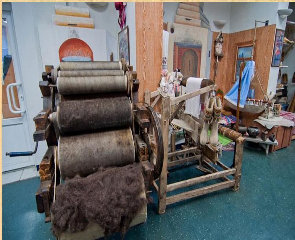
В XIX ВЕКЕ ИЗОБРЕЛИ ВАЛЯЛЬНЫЕ ПРЕССЫ И ВАЛЯЛЬНЫЕ МАШИНЫ. ВАЛКА ПРОИСХОДИЛА ПОСРЕДСТВОМ СДАВЛИВАНИЯ И ПРОКАТЫВАНИЯ ШЕРСТИ ИЛИ ПРИ МЕХАНИЧЕСКОМ ВОЗДЕЙСТВИИ СПЕЦИАЛЬНЫХ ИГОЛОК, КОТОРЫЕ СПУТЫВАЛИ ШЕРСТЯНЫЕ ВОЛОКНА:
