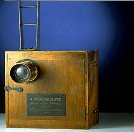
Один из первых киноаппаратов — «синематограф» братьев Люмьер.
