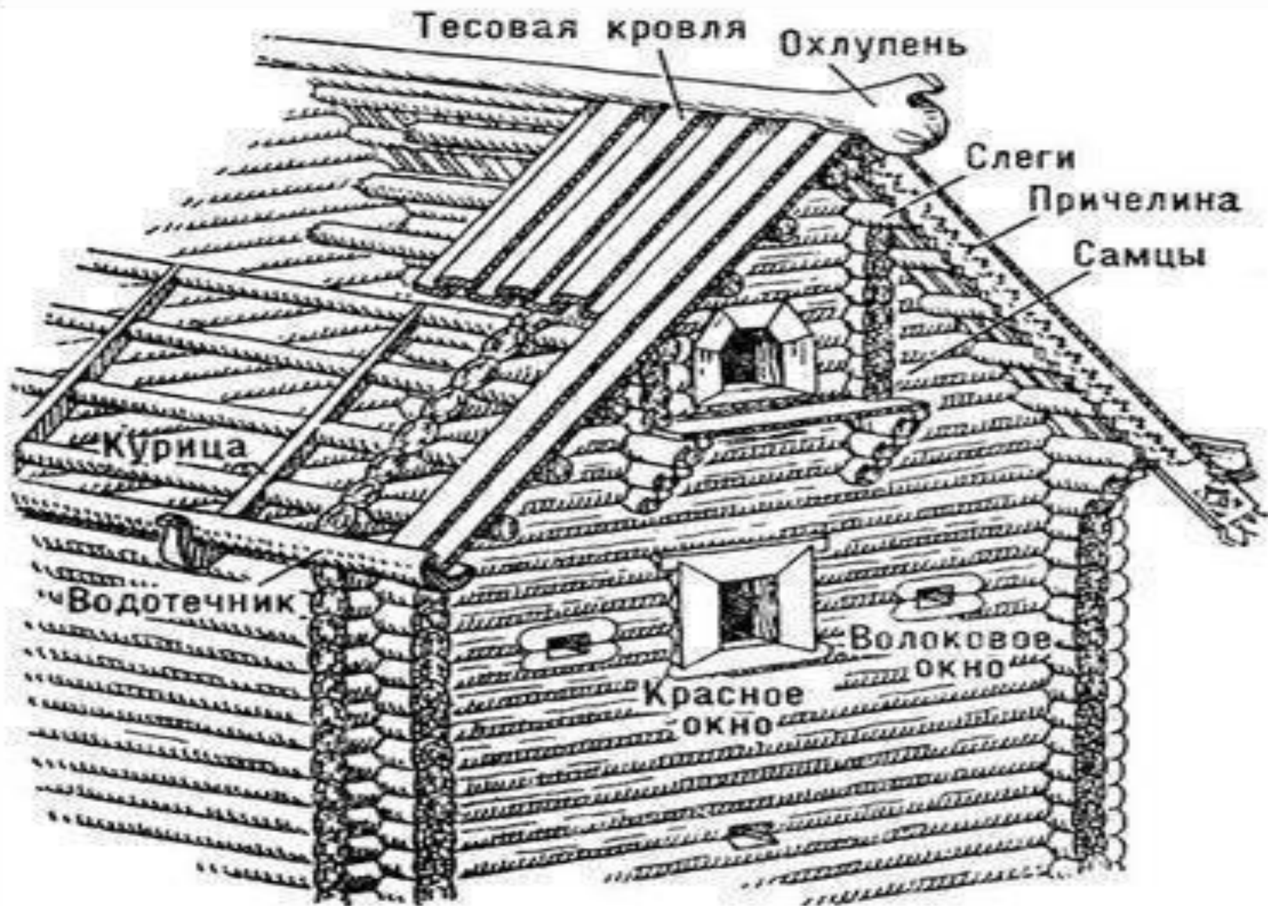
Схема конструкции рубленой избы
