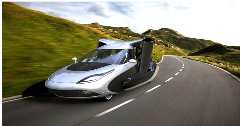
Концепт TF-X имеет два небольших складывающихся крыла с винтами на них, которые будут обеспечивать вертикальный взлет и посадку.
