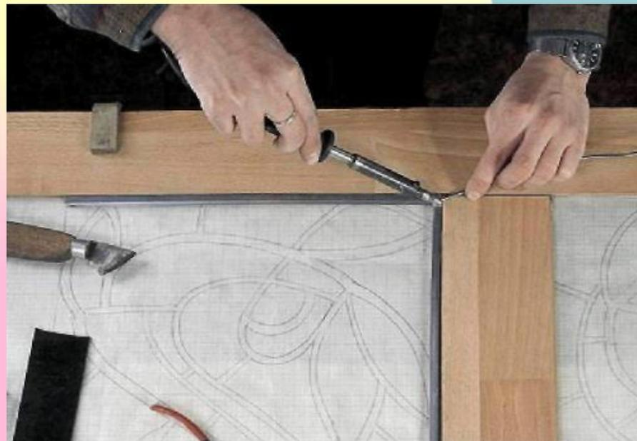
После установки полосок протяжки, соединяет их по углам с помощью пайки, получив таким образом свинцовую рамку витража.
