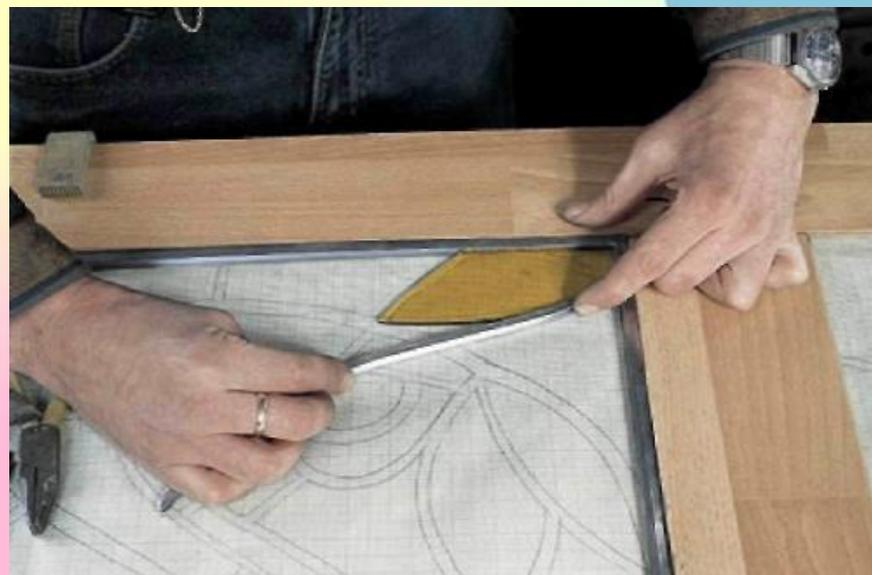
Вставляет в уголок рамы соответствующий фрагмент стекла и закрепляет его при помощи свинцовой протяжки .
