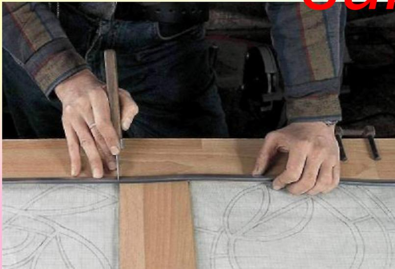
Закрепив рисунок витража на столе, столярным ножом художник нарезает куски свинцовой протяжки.
