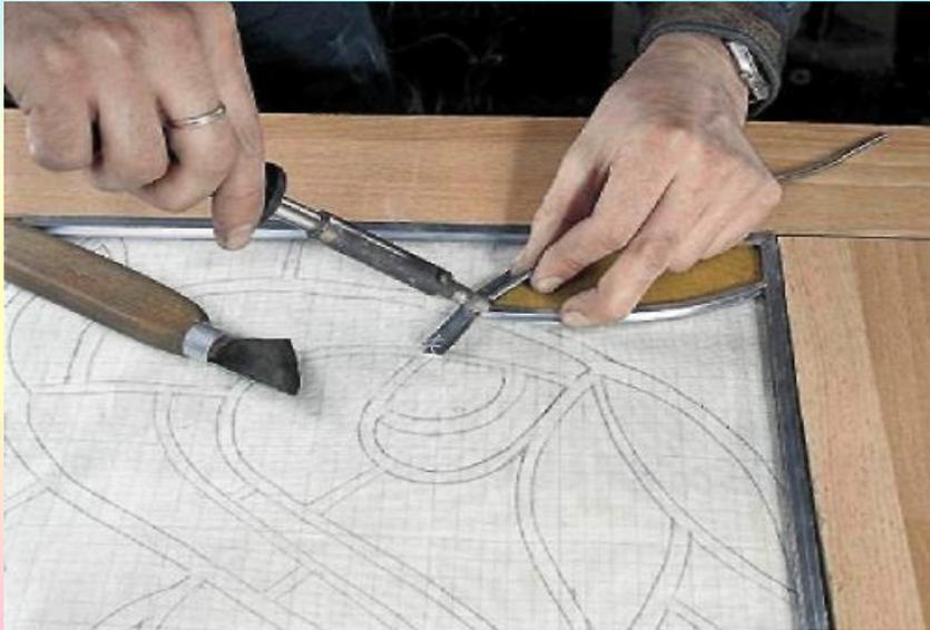
Полностью закрепляет получившийся фрагмент, соединив полоски протяжек между собой и припаяв их к свинцовой рамке.
