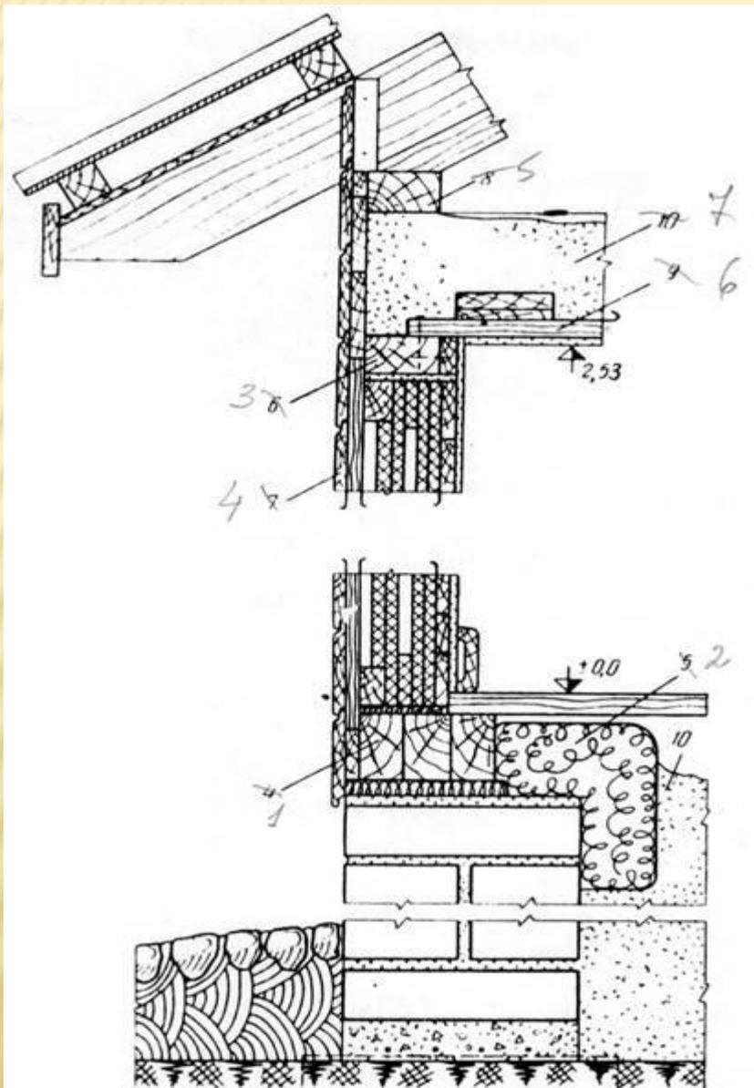
Стеновые щиты могут устанавливаться без каркаса. Их устанавливают в вертикальном положении и соединяют непосредственно между собой гвоздями (рис.9.9). щитовые стены делают одноэтажными.
