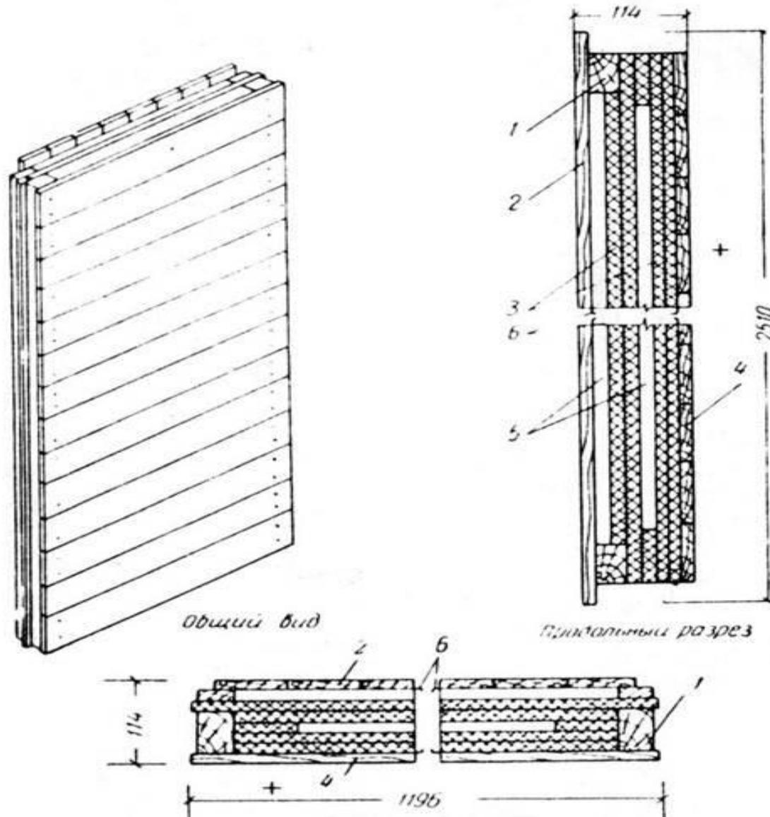
Рис 9.8. Стена щитового дома:
