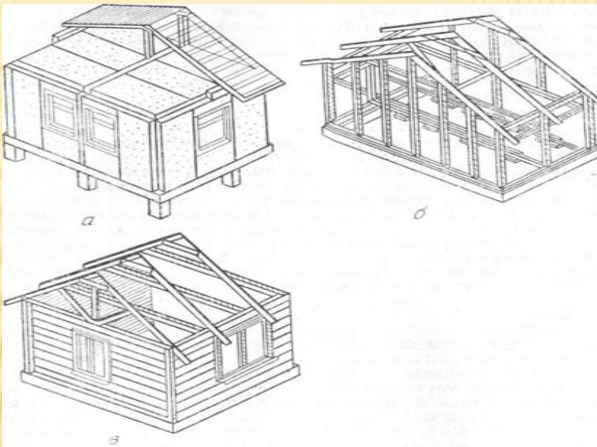
Типы одноэтажных деревянных домов: а — щитовой дом; б — остов каркасного дома; в — брусчатый дом
