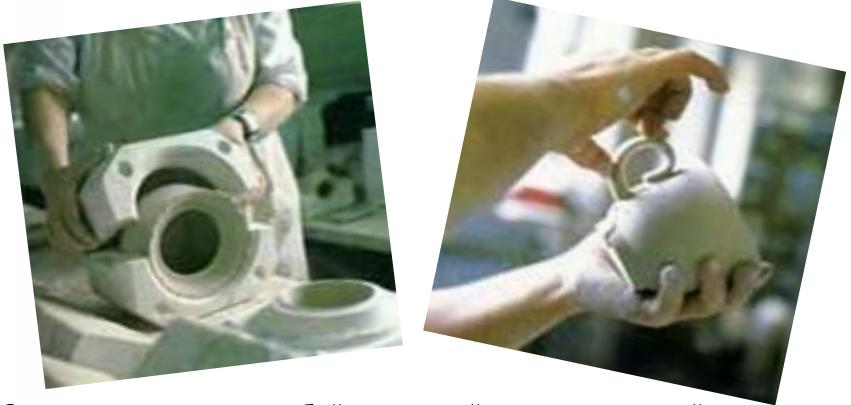
Станок представляет собой гончарный круг с двумя стойками и деревянной рейкой для упора рук. С помощью клюшек-резцов обрабатывается поверхность гипсовой заготовки с которой изготавливается рабочая форма для отливки изделий.
