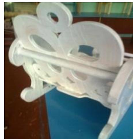
**Е** – есть такой инструмент – электрический лобзик. Им мы и выпиливаем контур и просечной декор на всех модулях...
