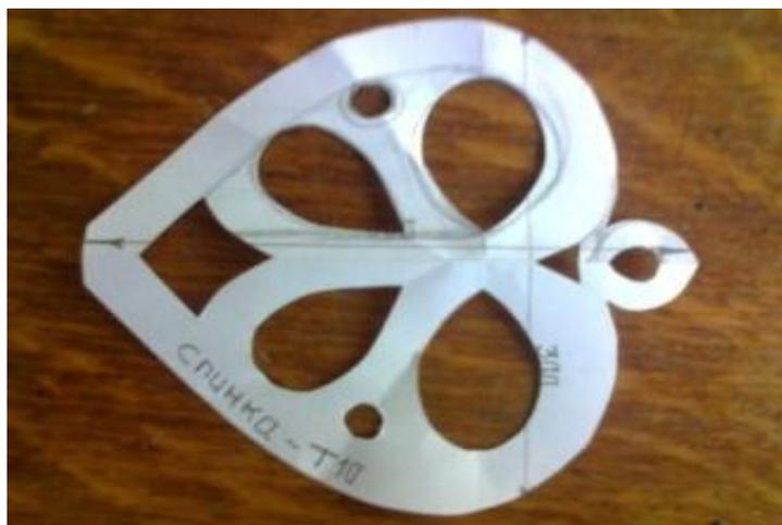
Изготовление шаблонов в масштабе остальных деталей с переносом контура на материал (сиденье, спинка, рейки, царга...)
