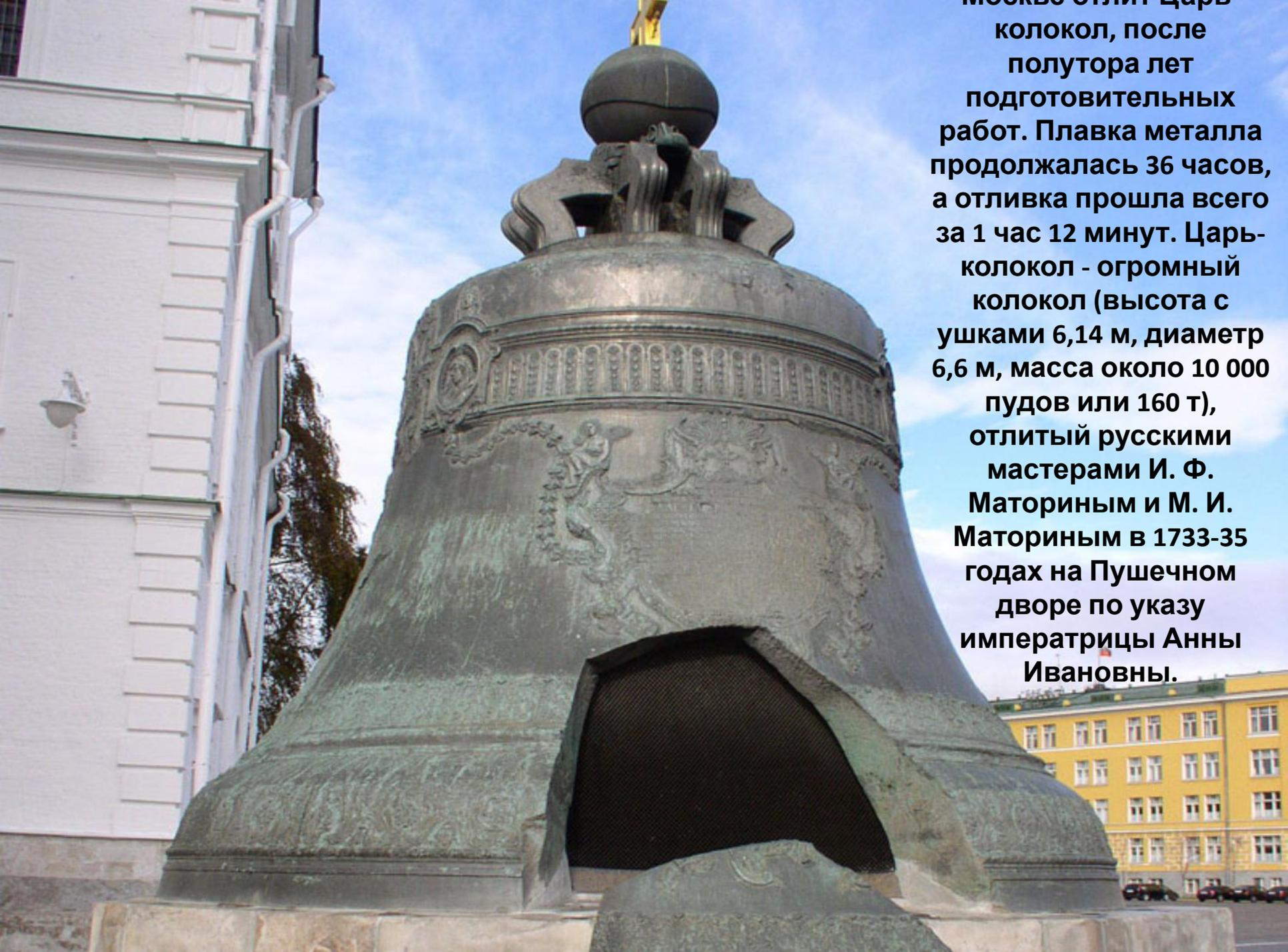
Царь-колокол, после полутора лет подготовительных работ. Плавка металла продолжалась 36 часов, а отливка прошла всего за 1 час 12 минут. Царь-колокол - огромный колокол (высота с ушками 6,14 м, диаметр 6,6 м, масса около 10 000 пудов или 160 т), отлитый русскими мастерами И. Ф. Маториным и М. И. Маториным в 1733-35 годах на Пушечном дворе по указу императрицы Анны Ивановны.
