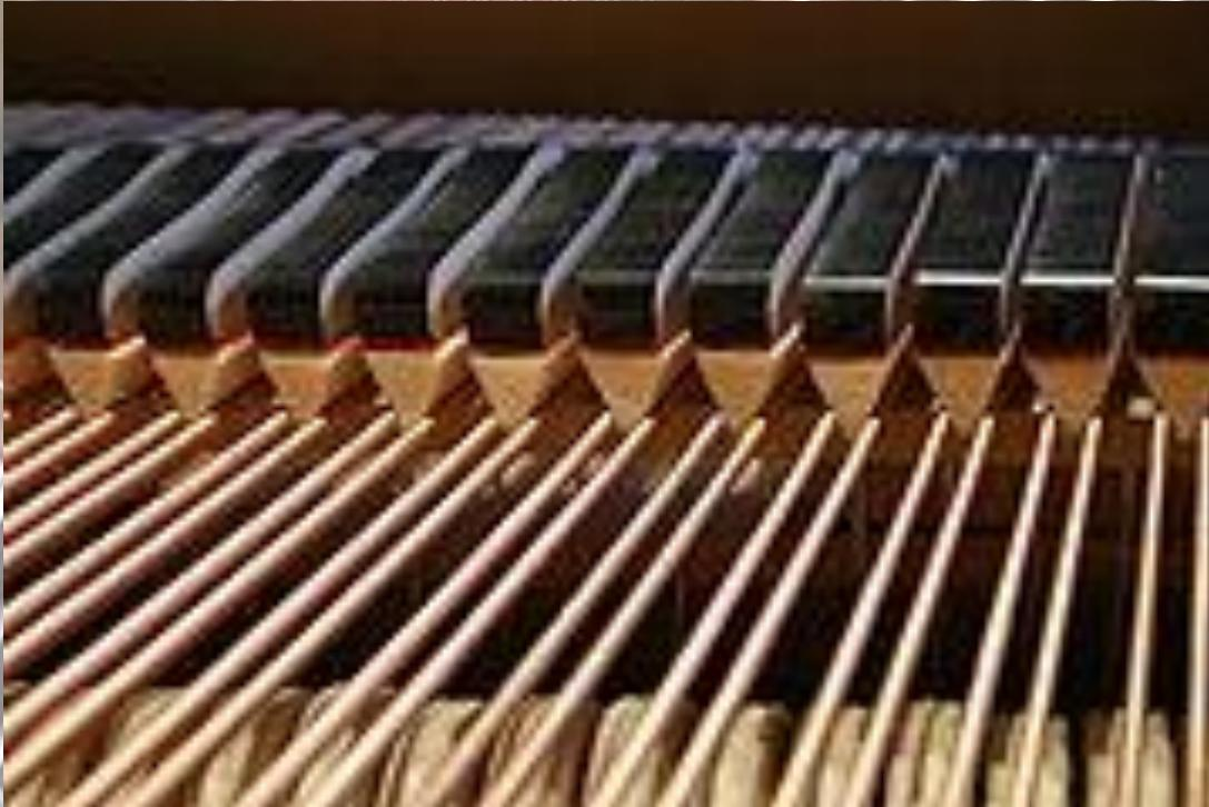
Рояль состоит из корпуса в котором над резонансной декой натянуты металлические струны, звучащие при ударе молоточками, приводимыми в движение клавишами. Посредством трех педалей можно:
