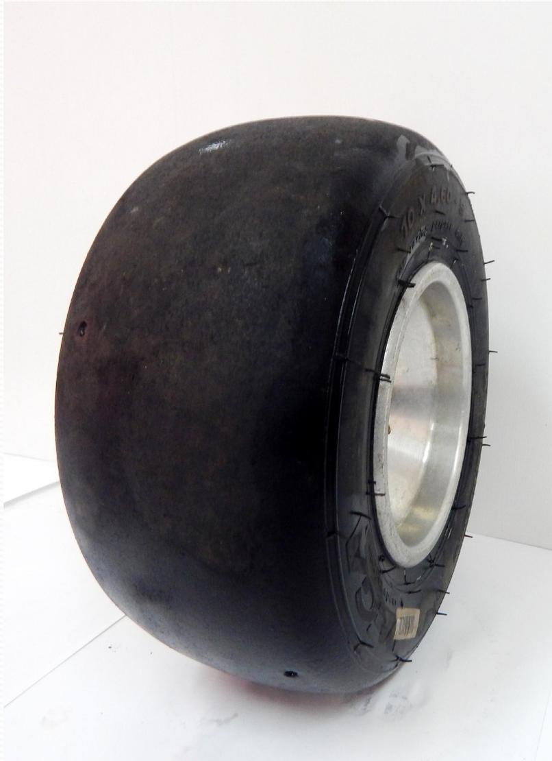
«Летняя» шина: жесткая, эластичная, без протектора. Имеет большую площадь сцепления с асфальтом. При прогреве, как бы слипается с асфальтом
