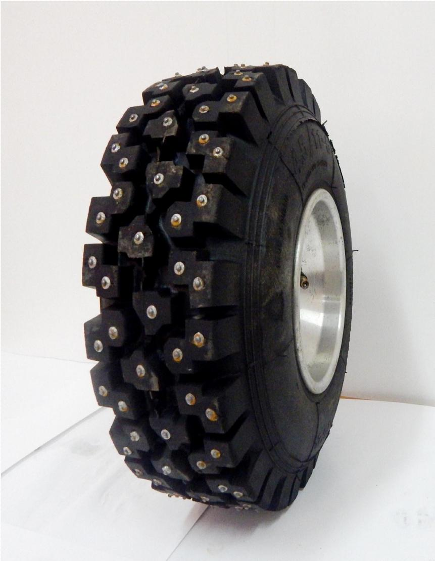
«Зимняя» шина: мягкая, эластичная, имеет глубокий протектор, который хорошо цепляется за снег, а также металлические шипы, которые врезаются в лед
