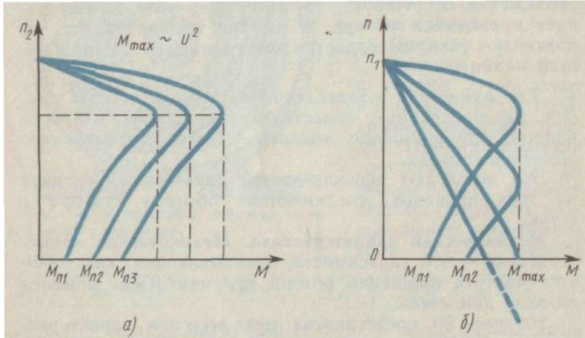
Помимо естественной для двигателя с фазным ротором могут быть получены искусственные механические характеристики. Для этого в цепь обмотки ротора включают добавочное сопротивление  $R_{доб}$ . Чем больше  $R_{доб}$ , тем круче спадает кривая  $n = f(M)$  (б), тем «мягче» становится механическая характеристика.
