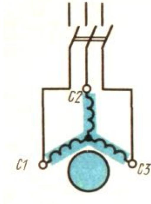
Напряжение в период пуска двигателя понижают: используя в период пуска соединение обмотки статора в звезду с последующим переключением ее на треугольник;
