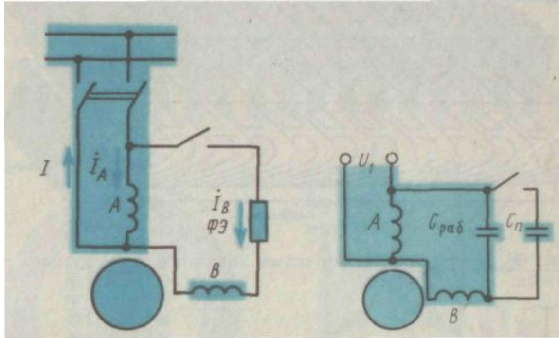
В однофазных асинхронных двигателях мощностью до 1—2 кВт имеется две обмотки : рабочая А и пусковая В, сдвинутые на половину полюсного деления (90 эл. град). Обе обмотки питаются от сети однофазного тока. Для создания вращающегося магнитного поля через пусковую обмотку должен проходить ток  $I_B$  со сдвигом по фазе на  $90^\circ$  по отношению к току  $I_A$  рабочей обмотки.
