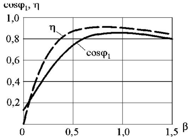
Асинхронные двигатели обладают высоким КПД. Например, КПД двигателей серии 5А мощностью от 1,5 до 250 кВт составляет соответственно 0,8... 0,96 (80..96%). Большие значения КПД соответствуют более мощным двигателям.
