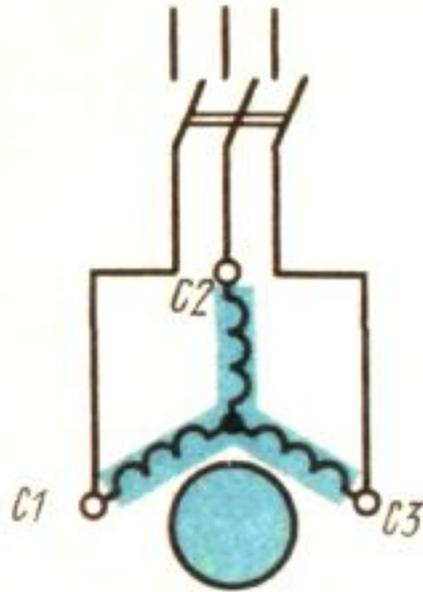
Кратковременный толчок пускового тока ( $I_{\text{пуск}} = 4-7 \cdot I_n$ ) безопасен для двигателя, но может явиться причиной чрезмерно большого падения напряжения в сети при недостаточной мощности источника энергии (обычно трансформатора). В этих случаях ограничивают пусковой ток пуском двигателя при пониженном напряжении.
