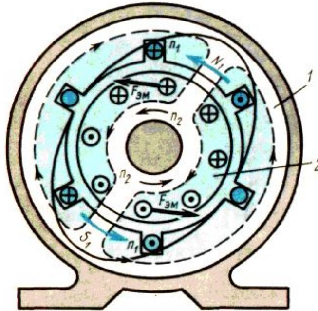
Вращающееся магнитное поле (показано пунктиром) пересекает проводники обмотки ротора и наводит в них ЭДС  $E_2$ . Под действием ЭДС в замкнутой обмотке ротора возникает ток  $I_2$ . На каждый проводник обмотки ротора, пересекаемый магнитным полем, действует электромагнитная сила  $F_{эм}$ . Силы, действующие на все проводники обмотки ротора, создают вращающий момент, увлекающий ротор вслед за полем.
