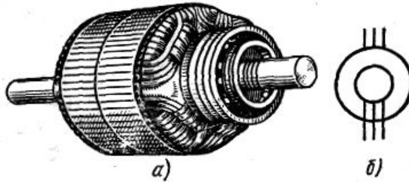
На боковом подшипниковом щите укрепляют щеткодержатель, причем так, чтобы расположенные в нем три группы угольных щеток надежно соприкасались с контактными кольцами ротора. Ротор с катушечной трехфазной обмоткой и контактными кольцами называют фазным. Машины с контактными кольцами допускают включение реостатов или дросселей в цепи роторов, чем обеспечивается возможность улучшения их пусковых и регулировочных свойств.
