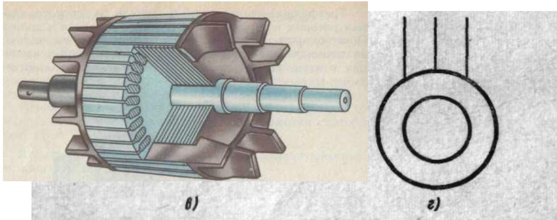
**Трехфазные асинхронные машины с короткозамкнутым ротором являются основной продукцией электромашиностроительных заводов. Поэтому их относят к типу машин основного исполнения. На электрических схемах трехфазные асинхронные машины основного исполнения обозначают стандартным символом, приведенным на рис. г.**
