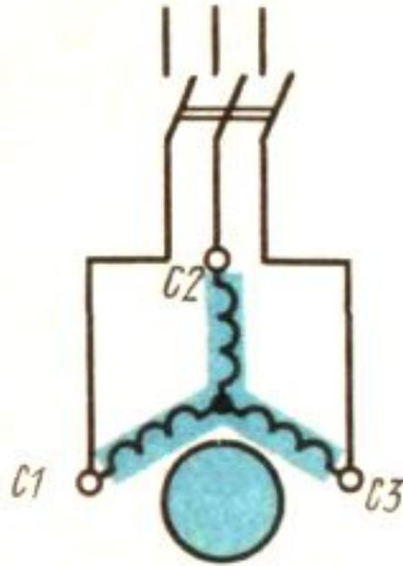
Пуск двигателя с короткозамкнутым ротором. Для двигателей с короткозамкнутым ротором обычно применяют прямое включение в сеть обмотки статора С1, С2, С3 с помощью соответствующей коммутационной аппаратуры.
