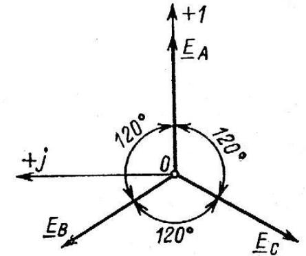
Для изменения направления вращения ротора, т. е. для реверсирования двигателя, необходимо изменить направление вращения магнитного поля, создаваемого обмоткой статора. Это достигают переключением двух фаз, т. е. двух из трех проводов, соединяющих обмотку статора с сетью.
