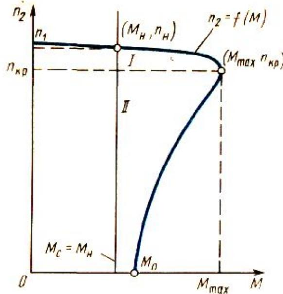
Характерные точки:  $0$ ,  $n_1$  — идеальный холостой ход;  $M_{\max}$ ,  $n_{кр}$  — максимальный момент, критическая частота вращения;  $M_H$ ,  $0$  — пусковой момент. Точкой  $M_{\max}$  кривая делится на две области: I — область устойчивой работы, где находится точка номинального режима  $(M_H, n_H)$ ; II — область неустойчивого режима, используемая при пуске или вынужденной остановке двигателя
