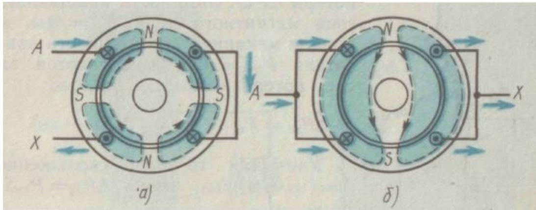
Кроме того, можно использовать переключение фазных обмоток статора с последовательного соединения (рис. а) на параллельное (рис. б). При этом число полюсов уменьшается и соответственно увеличивается  $n_1$ .
