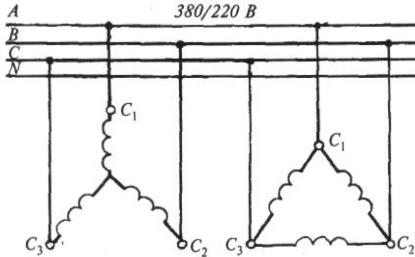
Соединение обмоток статора АД звездой и треугольником на клеммном щитке
