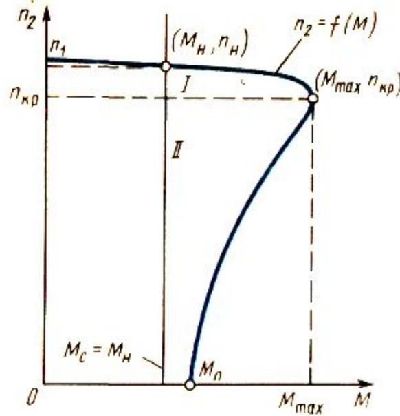
Двигатель в общем случае преодолевает некоторый момент сопротивления  $M_c$  со стороны механизма. Зависимость момента  $M_c$  от частоты вращения двигателя для разных механизмов различна.
