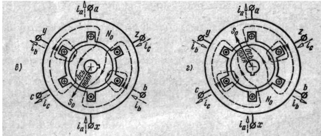
Картины результирующего поля, построенные на рисунке для различных моментов времени, показывают, что конфигурация линий магнитного поля по мере изменения токов в неподвижных катушках не изменяется; происходит лишь равномерное одностороннее вращение вокруг оси машины (например, по движению часовой стрелки) всего спектра магнитных линий поля, а следовательно, и вращение оси их симметрии. Такое поле принято называть вращающимся.
