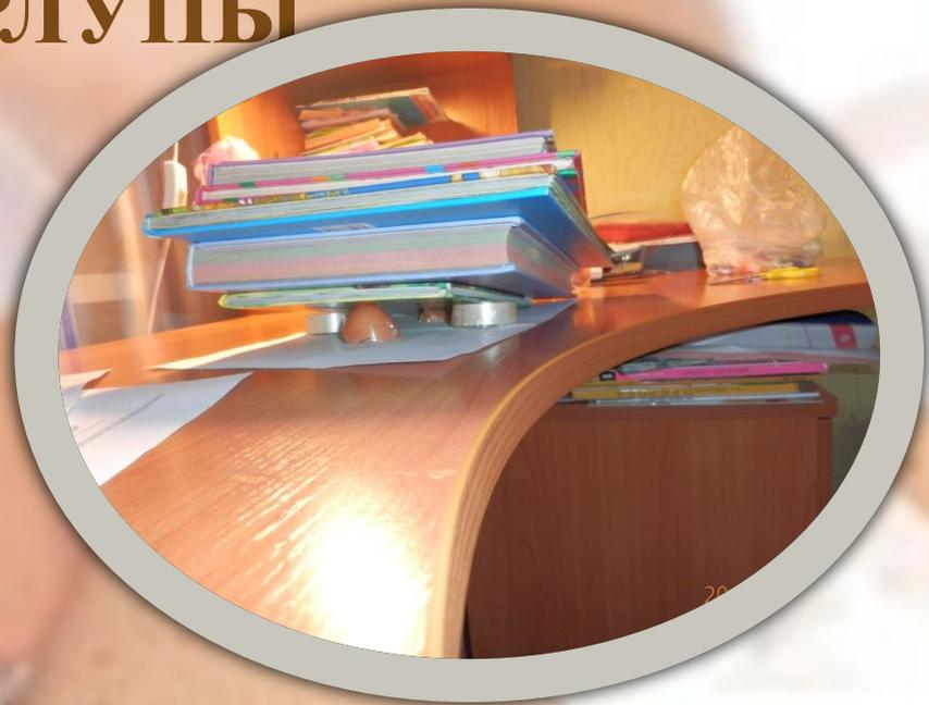
**Вывод:** скорлупки сильные, они выдерживают большой вес, так как имеют форму купола, поэтому тяжесть распределяется по всей поверхности. Скорлупки выдержали вес – 11кг.
