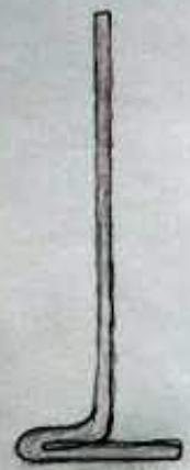
фиксатор для штиля проволока Ø6 мм.
