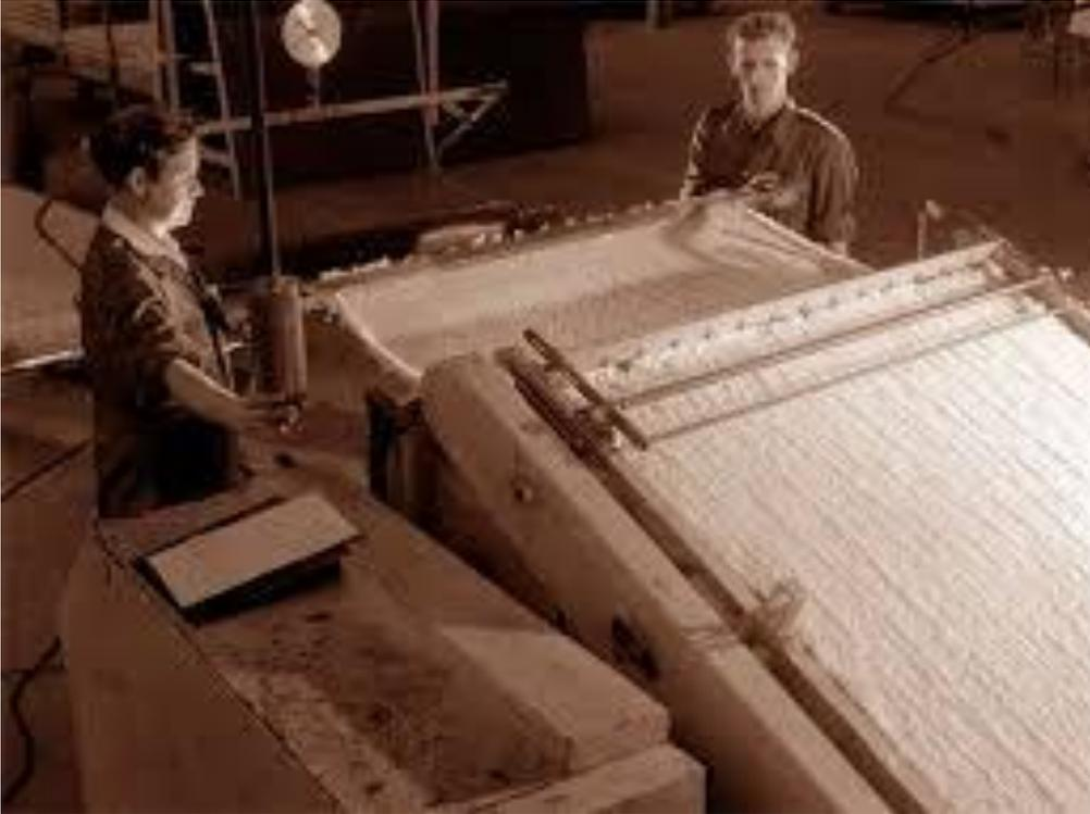
Асбеткань — это текстильное полотно, изготовленное на ткацком станке путем переплетения асбестовой пряжи. Пряжа состоит из асбестовых волокон и связующих нитей хлопка, вискозы или лавсана. Содержание связующих волокон в полотне варьируется от 5 до 18 процентов.
