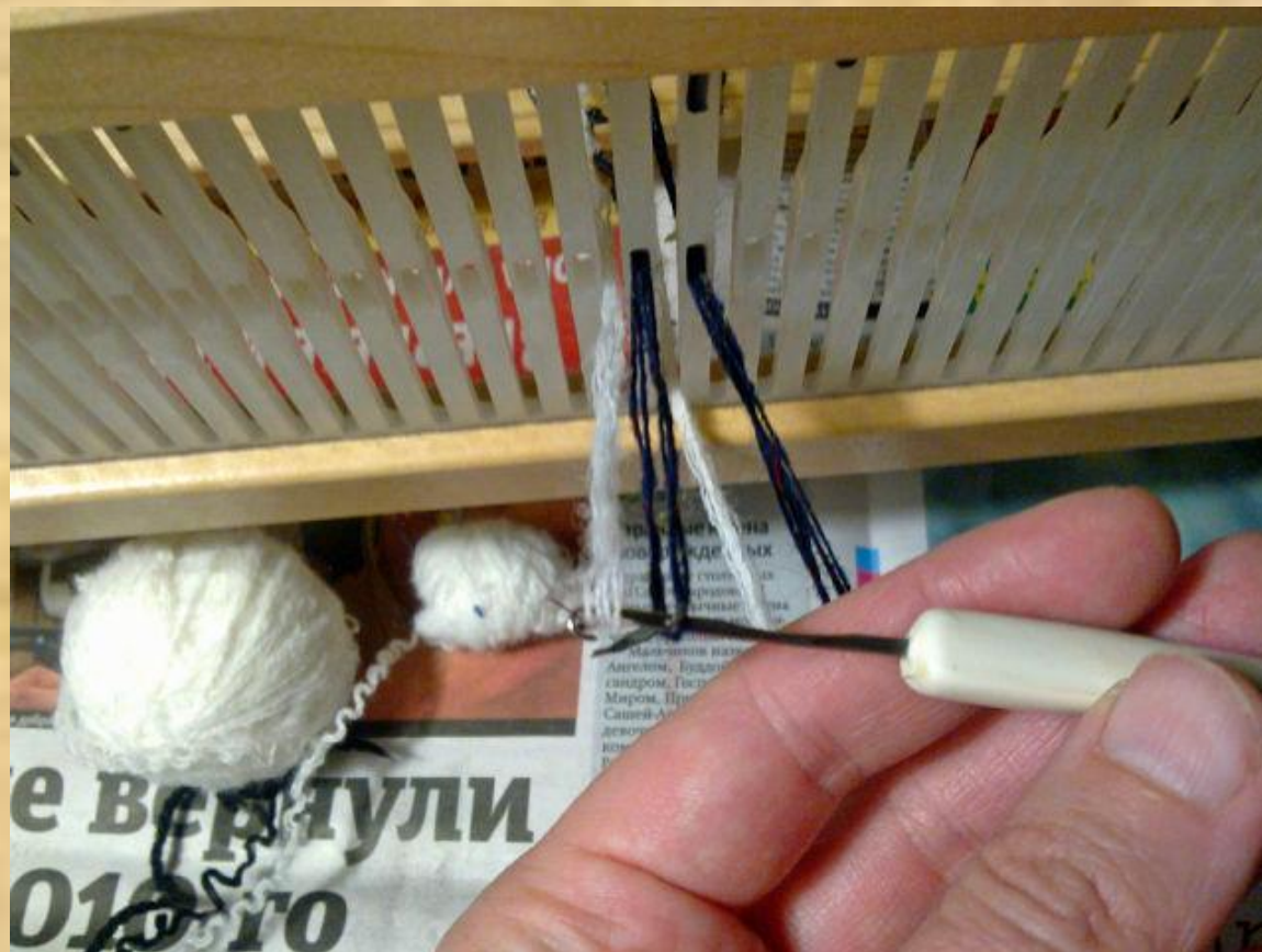
Протягивание концы нити основы через нитченки
