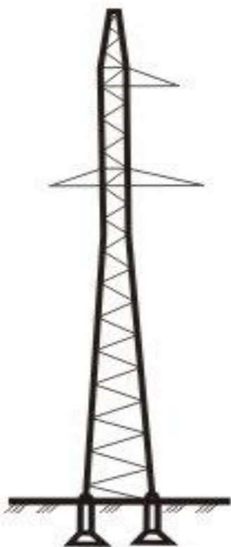
Промежуточная свободностоящая опора одноцепной ВЛ 110 кВ
