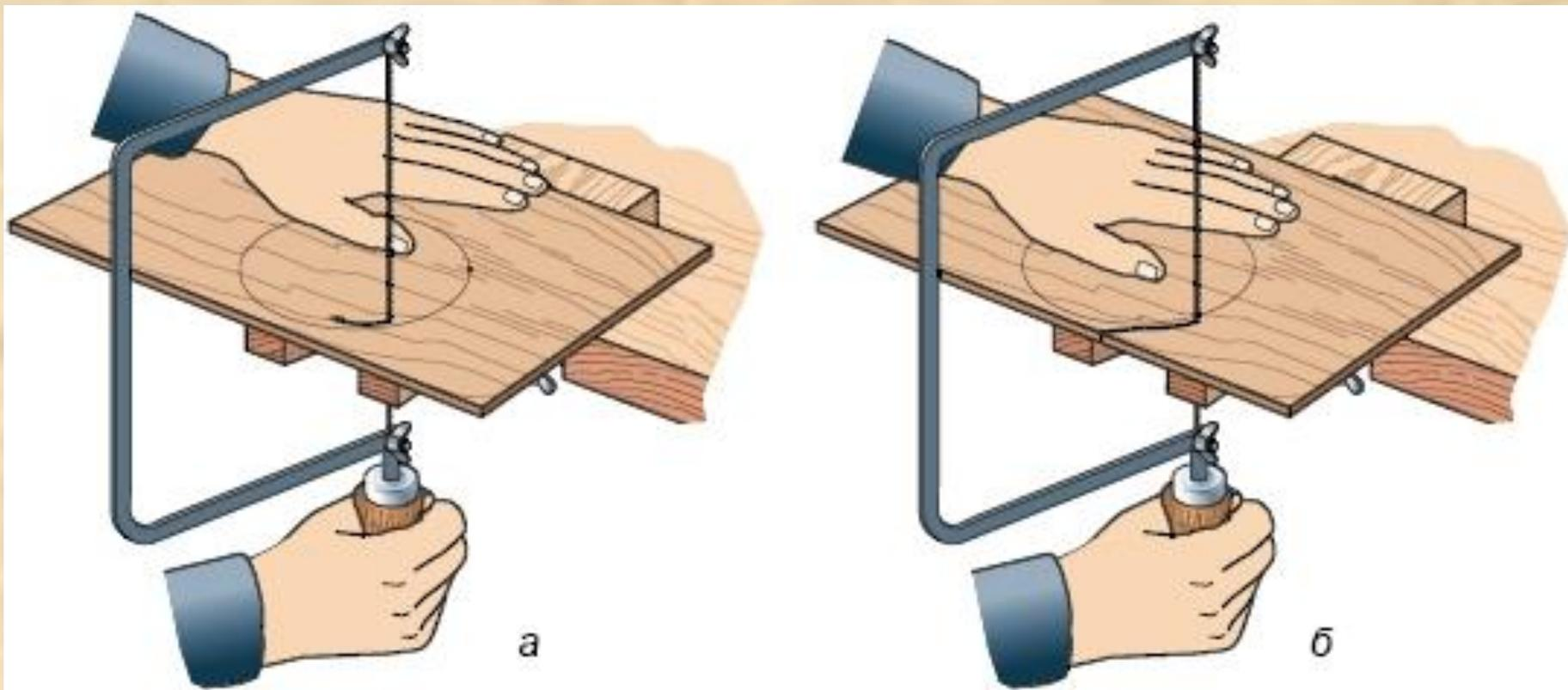
**Рис. 10. Выпиливание: а – по внутреннему контуру;
