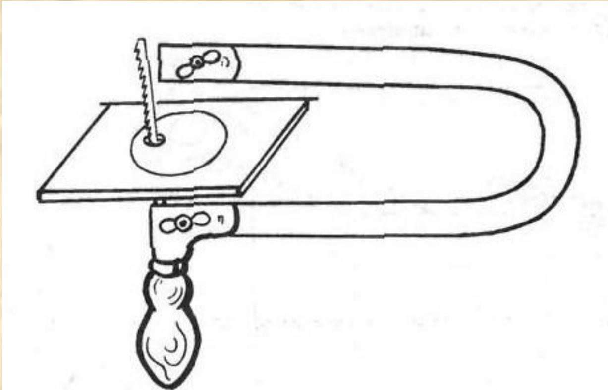
**Рис. 11. Технология вставки пилки лобзика во внутренний контур заготовки.**
