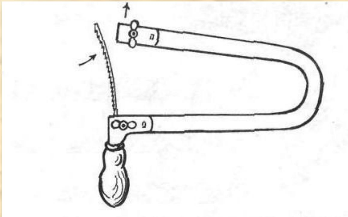
Рис. 3. Крепление пилки в лобзике.
