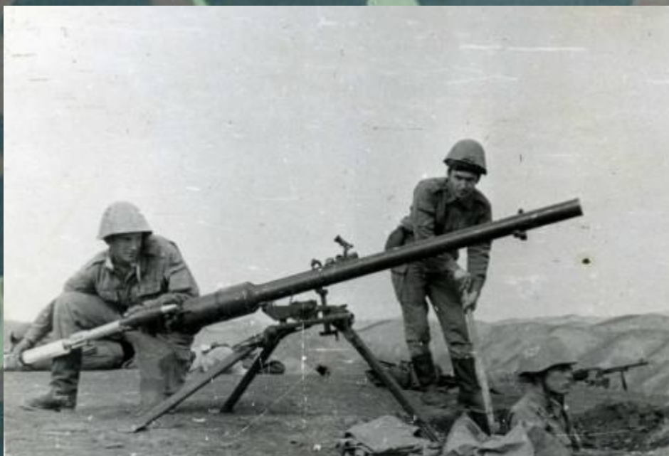
Заряжание станкового гранатомета СПГ-9
