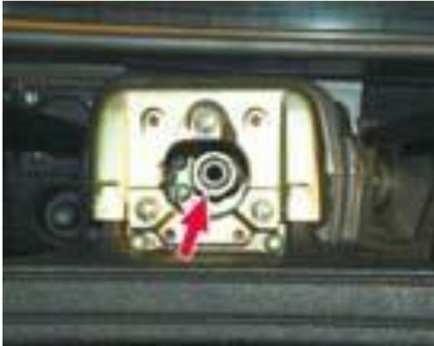
**Рулевое колесо очень плотно сидит на шлицах вала, поэтому не отворачивайте сразу гайку крепления колеса: при резком ударе рулевое колесо, соскочив со шлицев, может нанести травму. Для удобства дальнейшей установки промаркируйте положение рулевого колеса относительно вала.**
