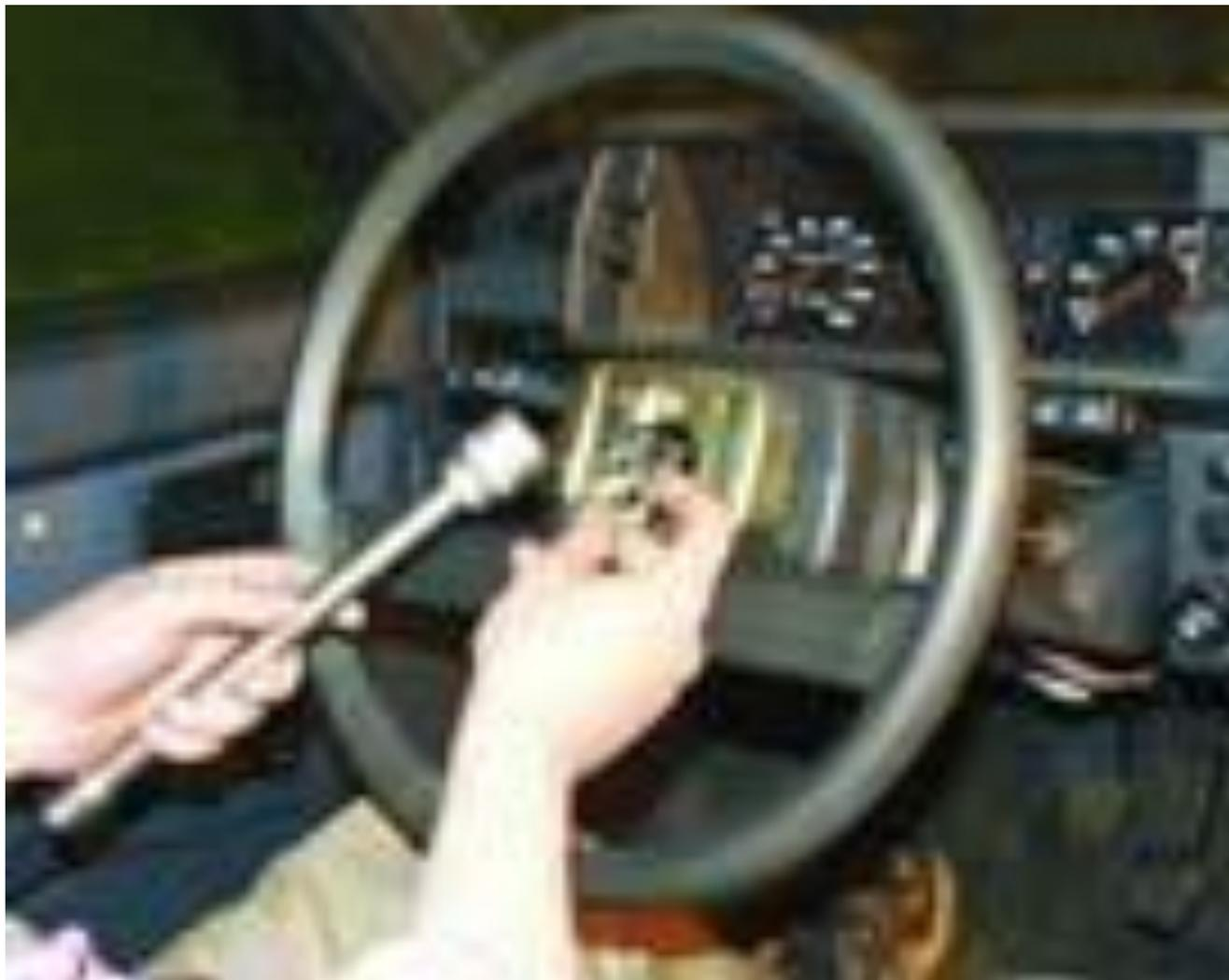
**Снимите рулевое колесо.**
