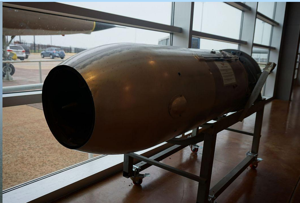
Турбореактивный двигатель Continental J69-T-29A Вид топлива: реактивное
