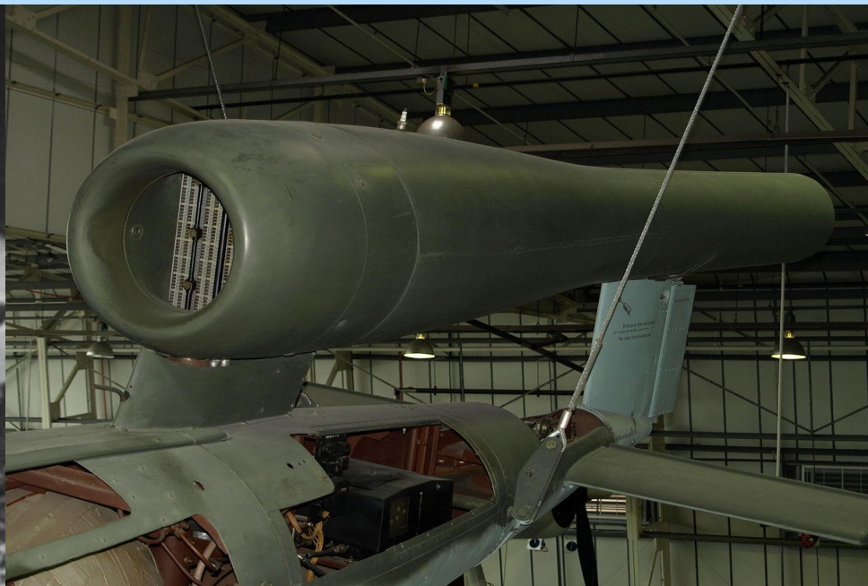
Воздушно-реактивный двигатель As109-014 Вид топлива: бензин А 80 + воздух
