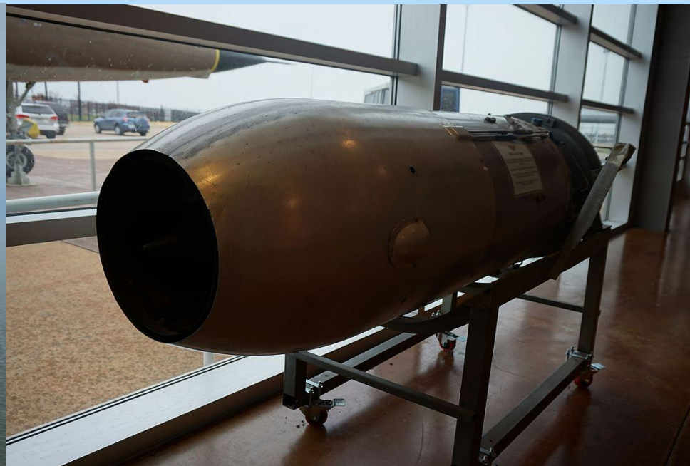
Турбореактивный двигатель Continental J69-T-29A Вид топлива: реактивное
