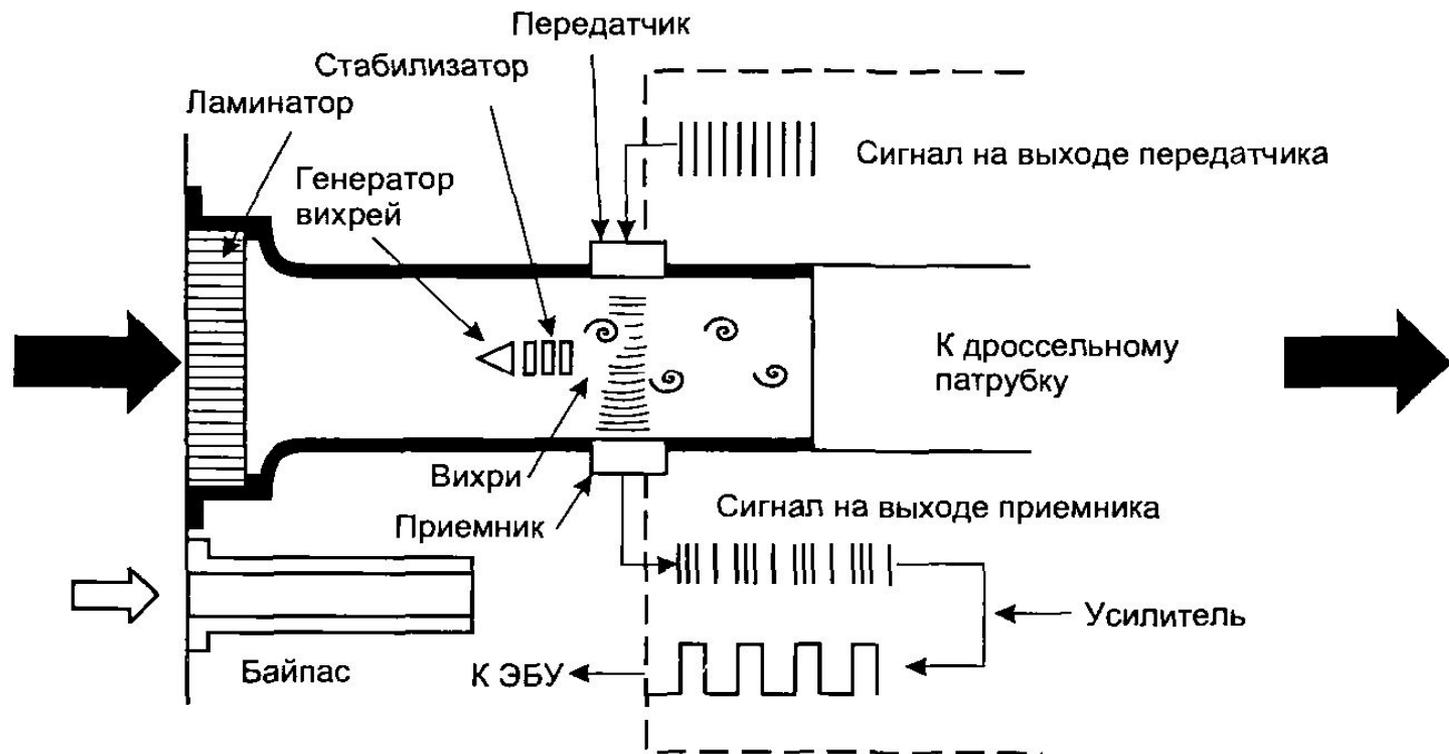
Рисунок 4.9 – Ультразвуковой датчик Кармана [19]
