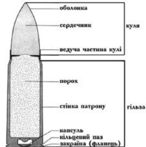
Рис. 13. Устрій патрона центрального запалювання: а — для гладкоствольної зброї; б — для нарізної зброї
