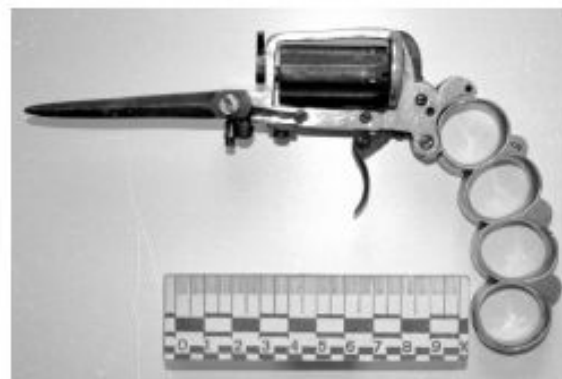
Рис. 12. Комбінована зброя – револьвер-кинжал-кастет у розкладеному стані
