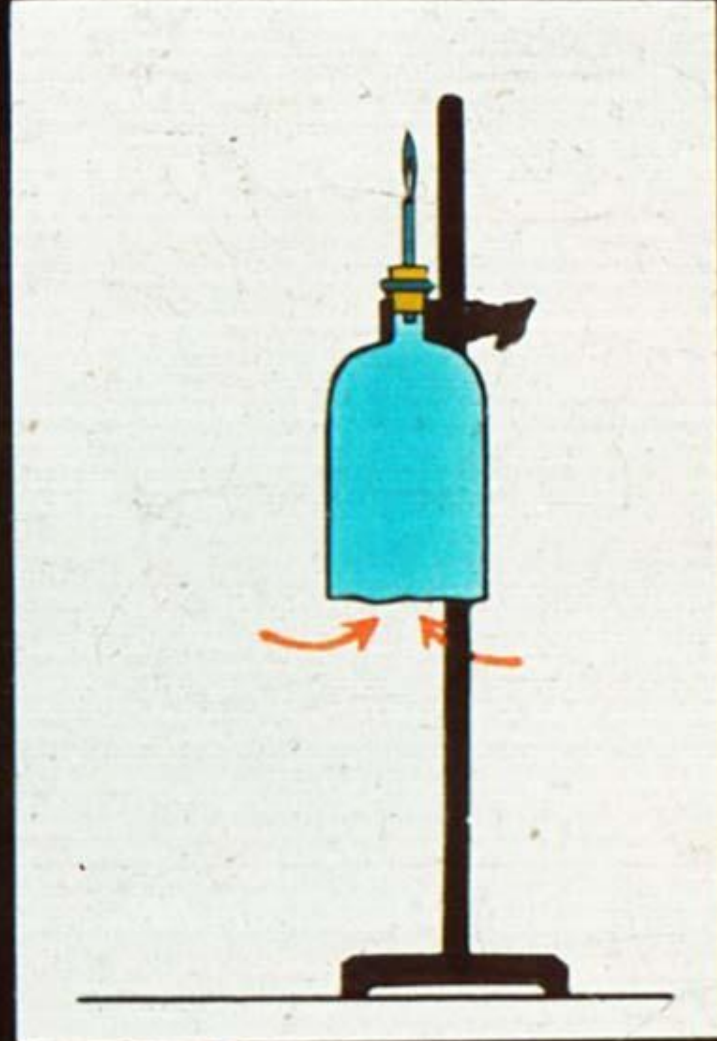
Взрыв смеси водорода с воздухом в колоколе.
