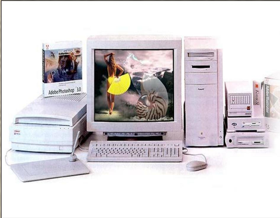
Современный настольный компьютер обычно состоит из нескольких устройств. Основной частью любого ПК является системный блок. Для отображения компьютерной информации используется монитор, а для ввода информации и управления компьютером — клавиатура и мышь. Кроме этого, к компьютеру можно подключать множество дополнительных устройств: принтер, сканер, джойстик, колонки и т.д.
