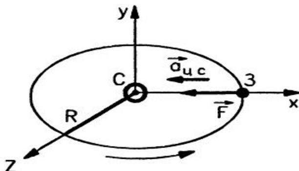
Согласно второму закону Ньютона:  $\vec{F} = m\vec{a}_{uc}$ .
