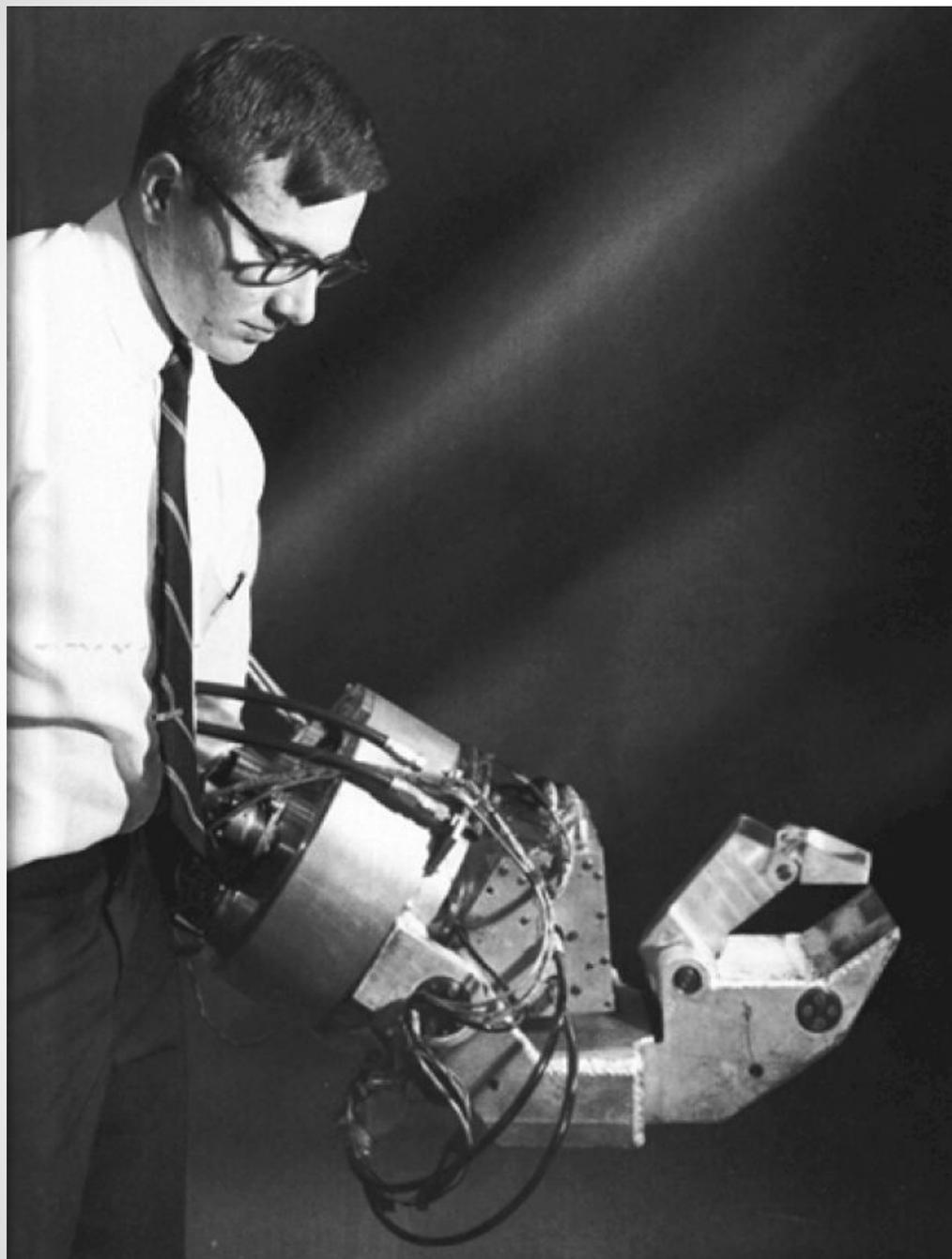
Дальнейшие исследования были сосредоточены на одной руке. Хотя она должна была поднимать 340 кг, её вес составлял 750 кг, что в два раза превышало подъемную мощность. Без соединения вместе всех компонентов практическое применение проекта Hardiman было ограничено.
