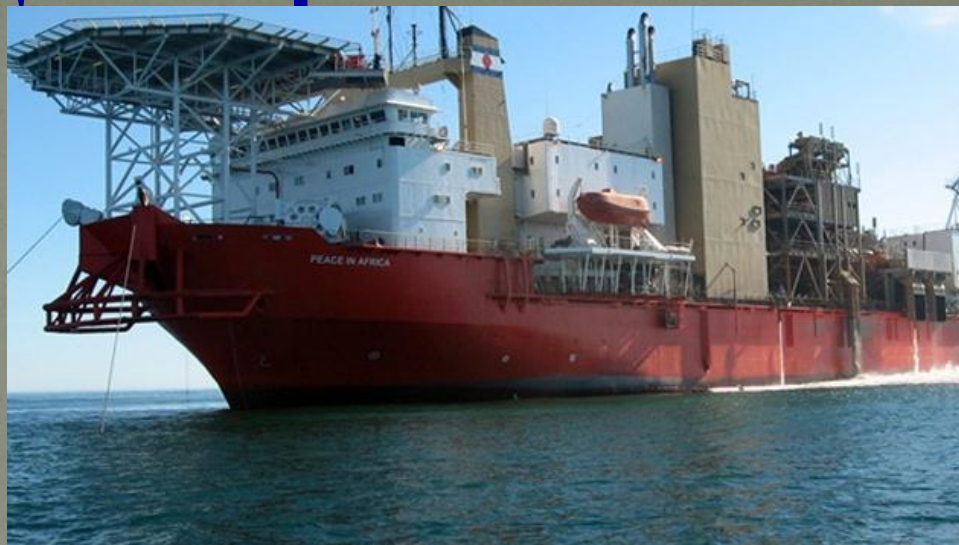
Танкер с оборудованием для добычи металла со дна моря
