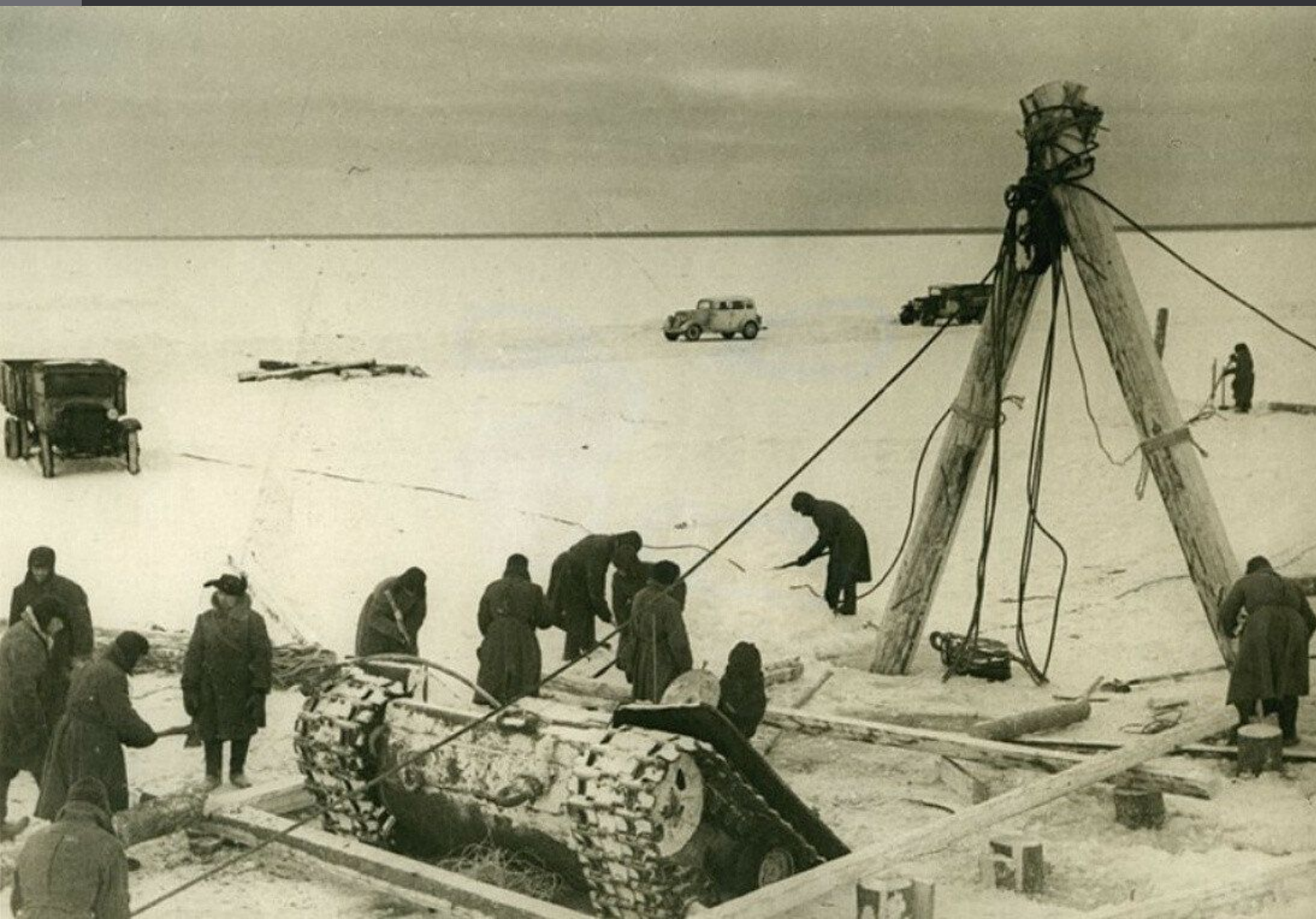
Подъём танка КВ-1, провалившегося под лёд Ладоги.
